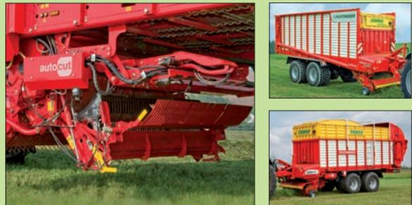
„autocut“ Messerschleifeinrichtung für JUMBO und TORRO
