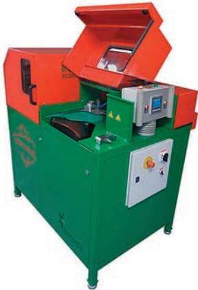
Die Auto SILA 500 vom Hersteller Benedict arbeitet vollautomatisch ohne Hilfsperson, und beschickt die Maschine aus einer Kassette, die bis zu 100 Messer fasst.
