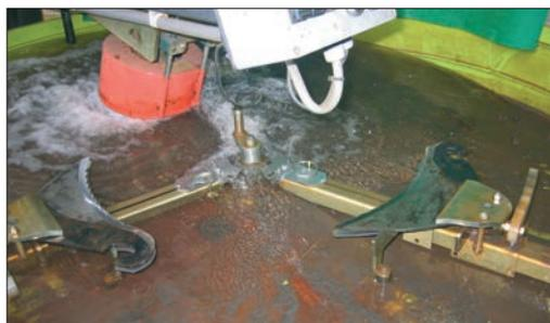
**Dieser Halbautomat von Claas ist wesentlich teurer als ein Trockenschleifer, schleift die Messer im Wasserbad aber schonender. Im «Aqua Non Stop» können bis zu sechs Messer auf einmal eingespannt und geschärft werden.**
