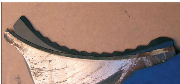
**Durch falsches Schärfen wird der Radius des Messers verändert und Futter kann das Schneidwerk ungeschritten passieren.**
