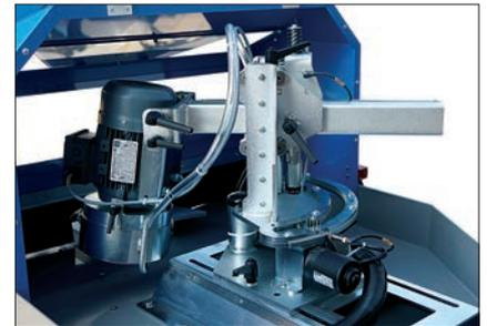
**Der vollautomatische Schleifer Autogrind AG100 arbeitet prozessorgesteuert**
