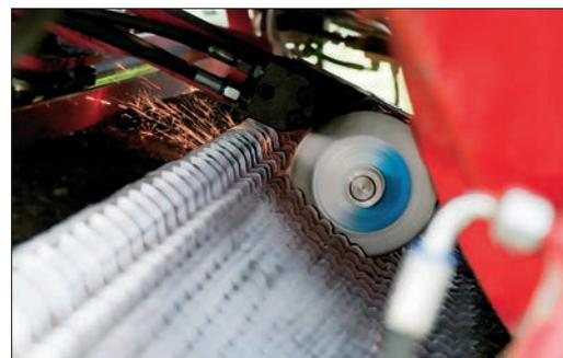
Der Messerschleifautomat Autocut von Pöttinger schärft die Messer direkt am Schneidwerk, ohne dass sie dazu ausgebaut werden müssen.
