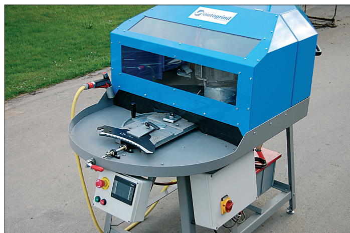
Autogrind AG100 schleift alle bogenförmigen Messer vollautomatisch.
